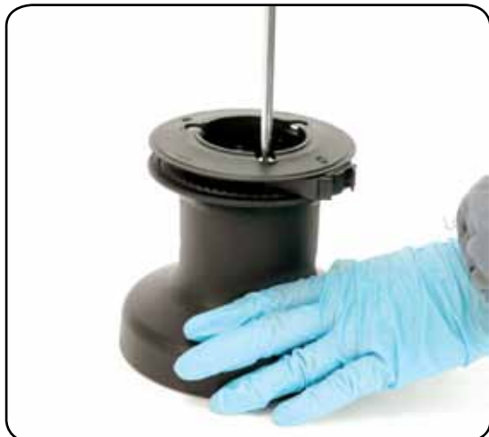
I. Unscrew the 3 screws n°14 ( \approx 4\text{Nm}/35\text{ in-lb} )
