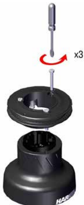
I. Unscrew the 3 screws ( \approx 4\text{Nm}/35\text{ in-lb} )
