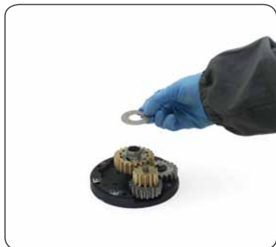
9. Remove the washer n°11
