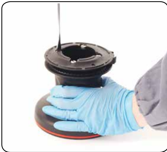
I. Unscrew the 4 screws ( \approx 4\text{Nm}/35\text{ in-lb} )
