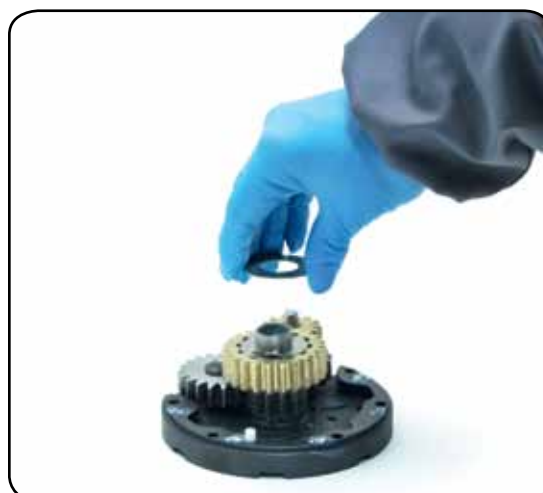
11. Remove the washer n°12
