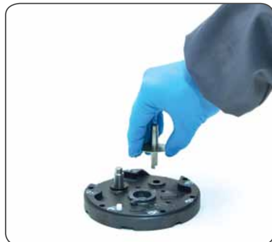
17. Remove washer n°9 and pin n°8
