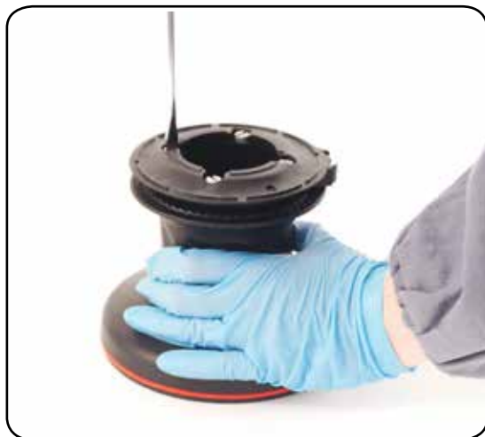
I. Unscrew the 4 screws ( \approx 4\text{Nm}/35\text{ in-lb} )
