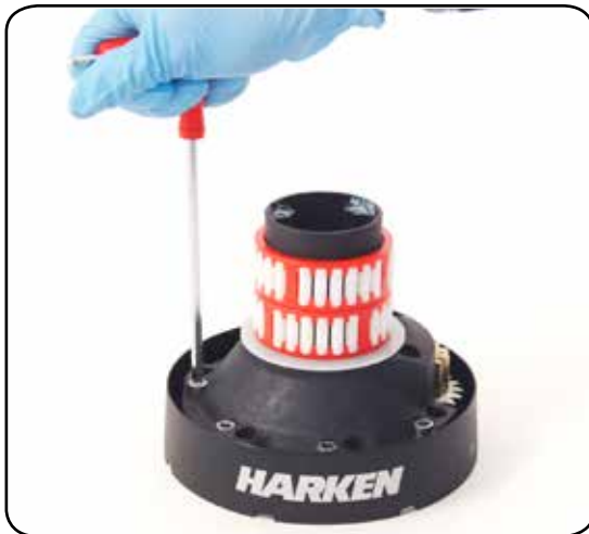
8. Unscrew the 6 hex screws ( \approx 8\text{Nm}/70\text{ in-lb} )
