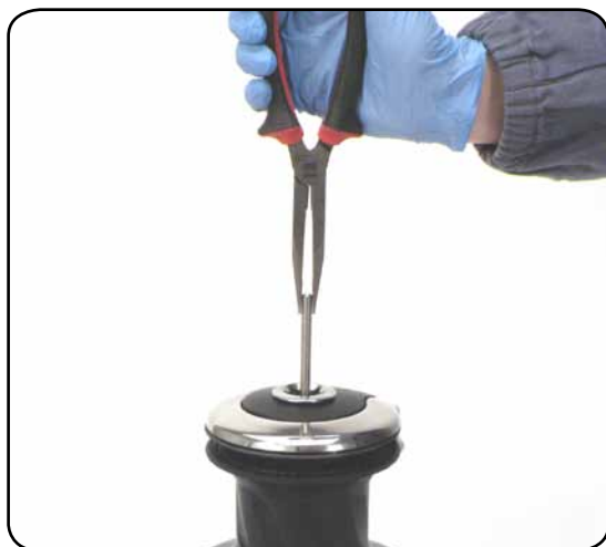
1. Pull out the disconnect rod n°30
