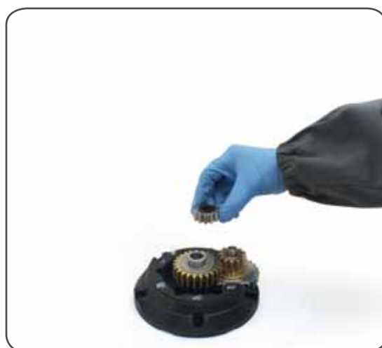
9. Remove the gear n°14
