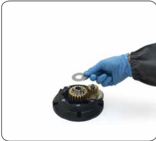
10. Remove the washer n°12
