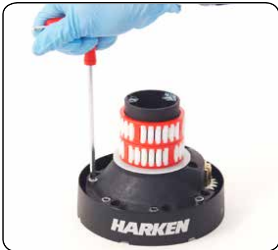
8. Unscrew the 6 hex screws ( \approx 20\text{Nm}/177\text{ in}\cdot\text{lb} )
