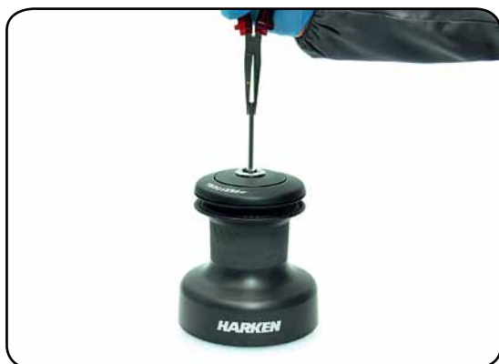
1. Pull out the disconnect rod n°30
