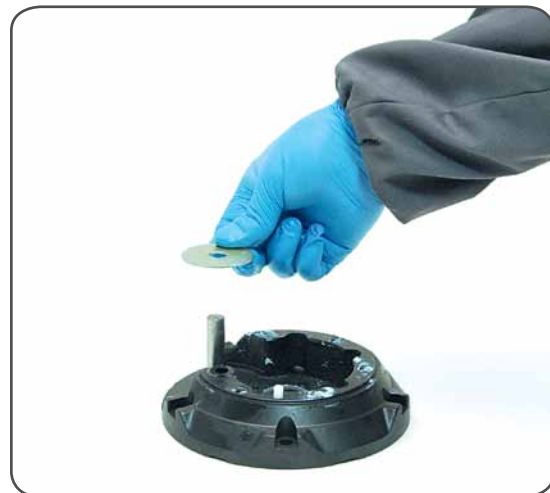
17. Remove the washer n°4.
