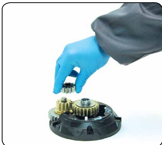
11. Remove the gear n°14
