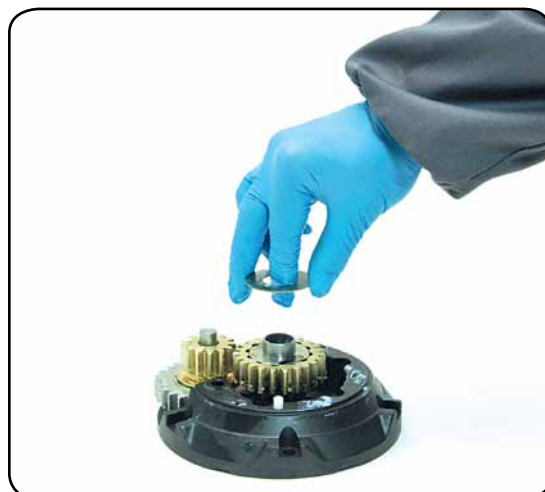
12. Remove the washer n°12
