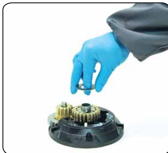
12. Remove the washer n°12
