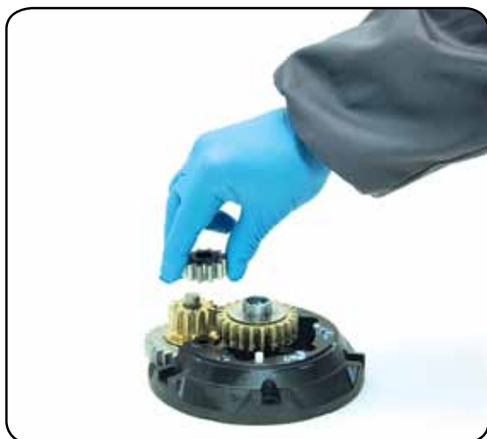
11. Remove the gear n°14
