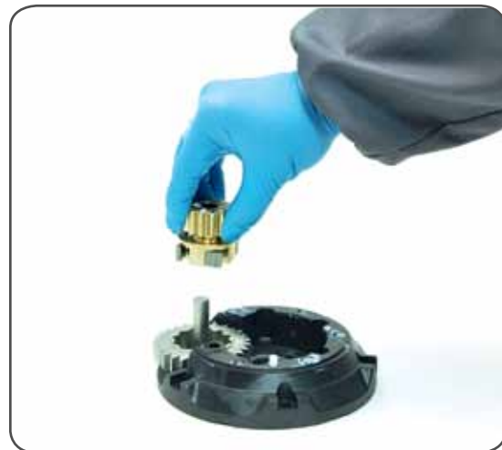
15. Remove the pinion n°10.
