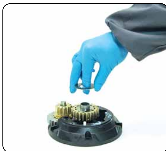
11. Remove the washer n°12
