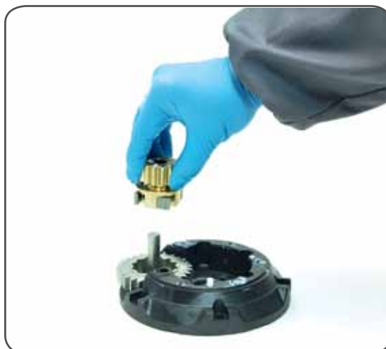
14. Remove the pinion n°10.
