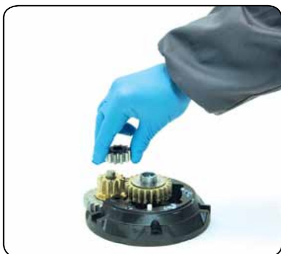
10. Remove the gear n°14
