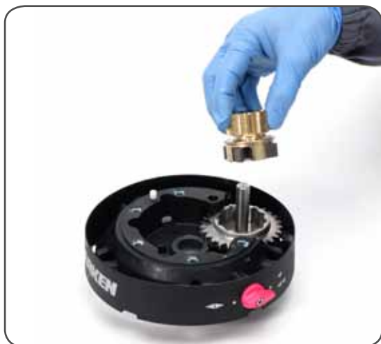
13. Remove the pinion n°7
