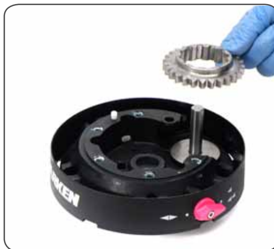
14. Remove the gear n°20
