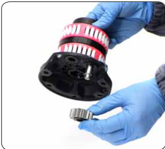
9. Slide out the gear n°10
