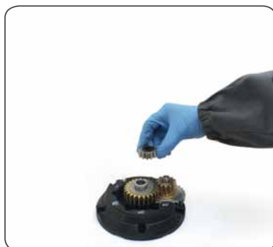
9. Remove the gear n°15
