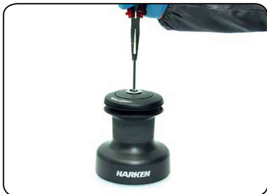
1. Pull out the disconnect rod n°30
