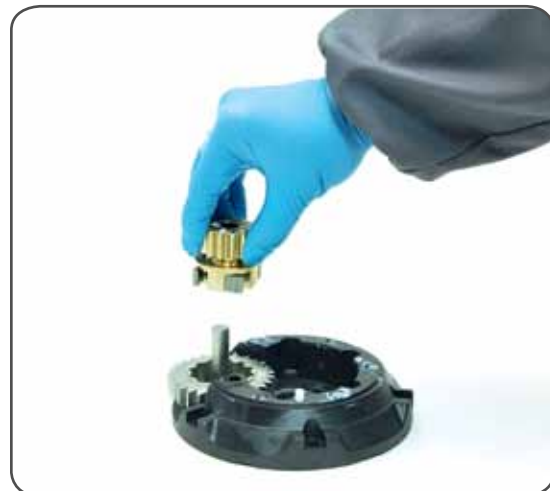
14. Remove the pinion n°10.
