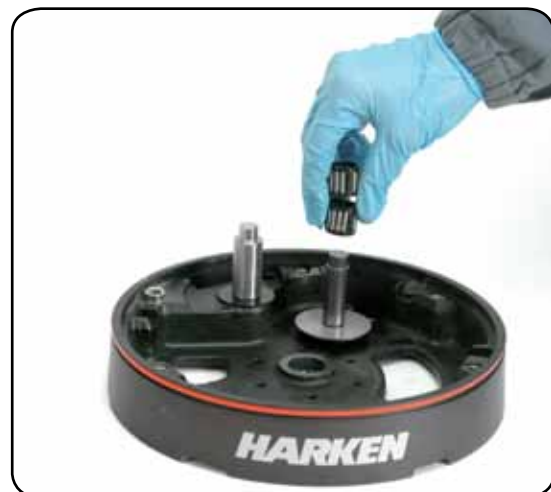
17. Remove roller bearings n°12
