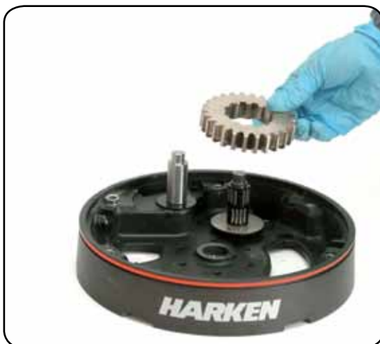
16. Remove the gear n°10
