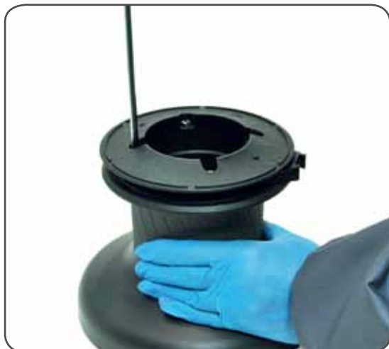
I. Unscrew the 4 screws n°24 ( \approx 4\text{Nm}/35\text{ in-lb} )
