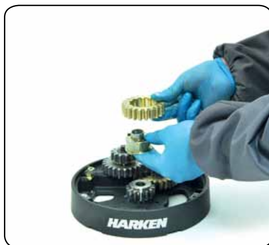
11. Remove gear n°6, pawls n°3 and washer n°7
