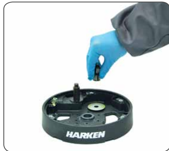
17. Remove roller bearings n°12.
