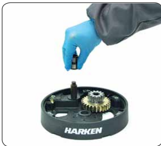
14. Remove roller bearings n°15
