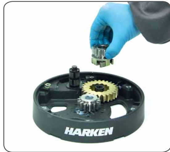
15. Remove the pawl carrier n°11
