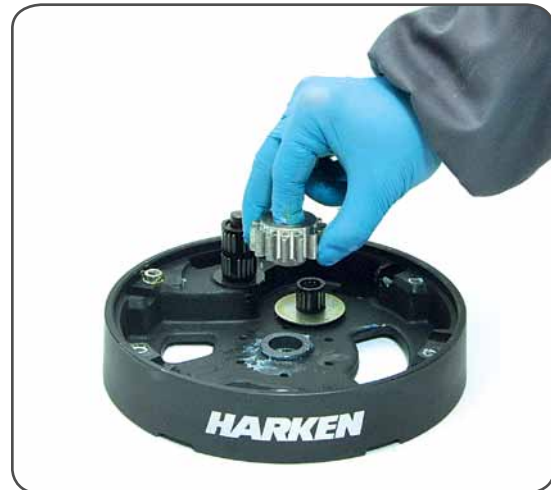
17. Remove the gear n°2
