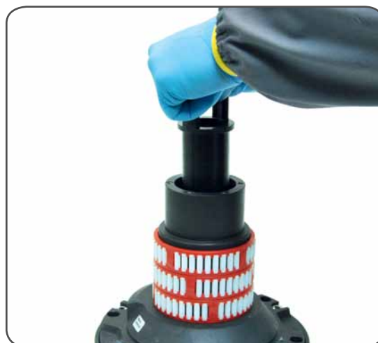
8. Slide out the assy clutch n°36
