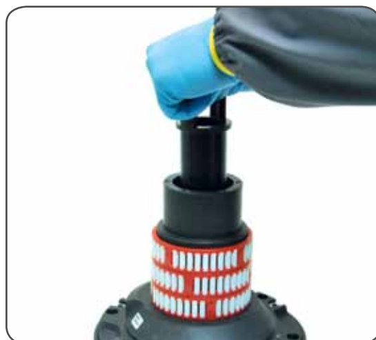
8. Slide out the assy clutch n°36
