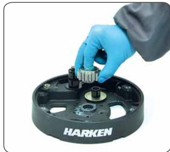
17. Remove the gear n°2
