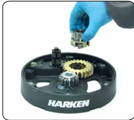
14. Remove the pawl carrier n°11
