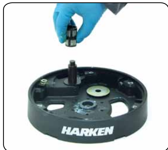
18. Remove roller bearings n°15
