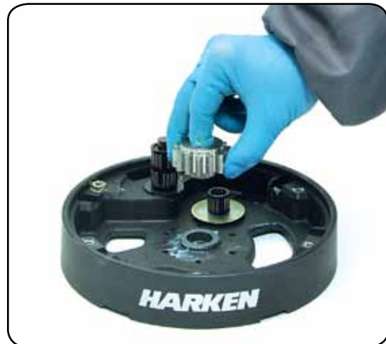
16. Remove the gear n°2
