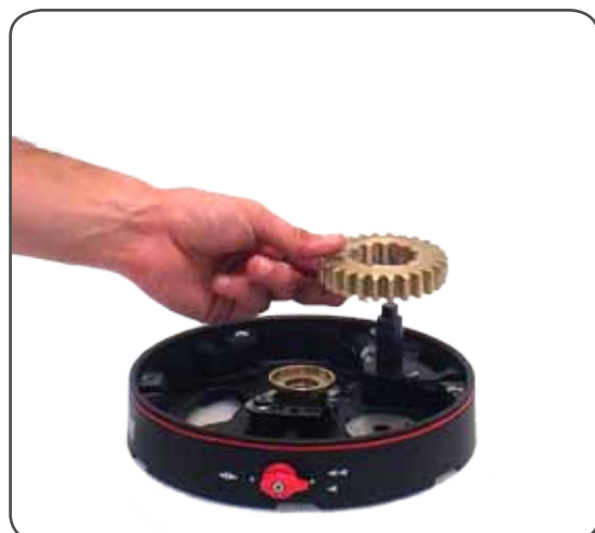
13. Remove the ratchet gear n°7
