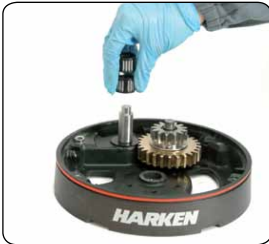
14. Remove roller bearings n°15
