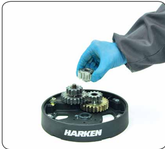
13. Remove the gear n°2.
