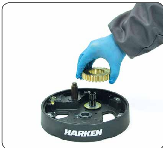
17. Remove the gear n°10
