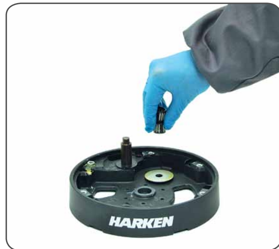
18. Remove roller bearings n°12.
