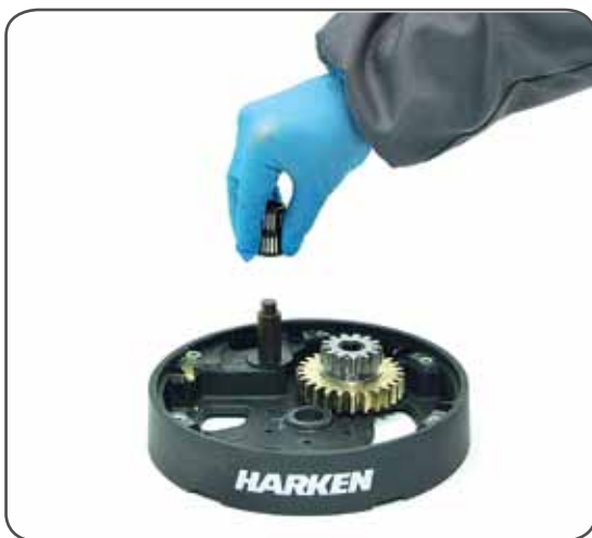
14. Remove roller bearings n°15
