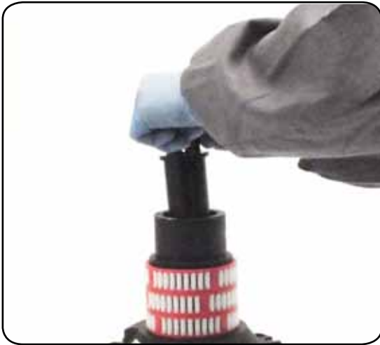
7. Slide out the assy clutch n°38
