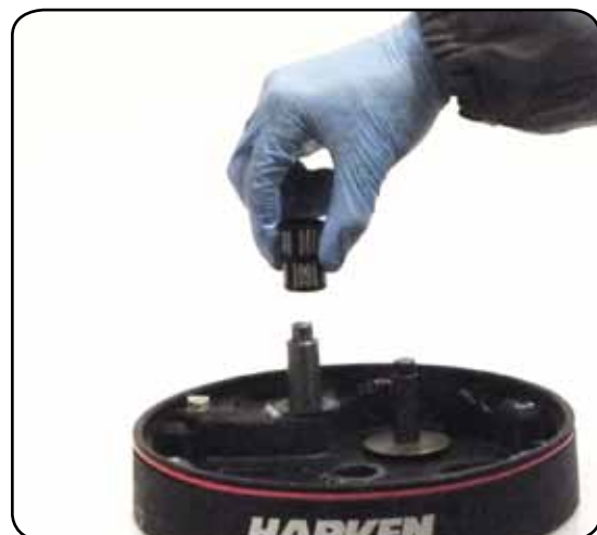
18. Remove roller bearings n°15
