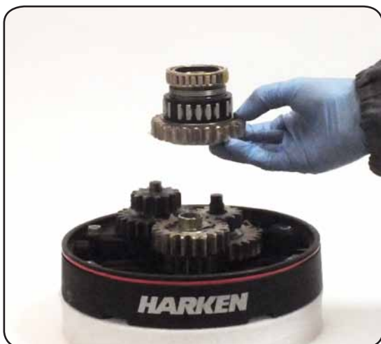
12. Remove the gear n°34, pawls carrier n°33, the bearings n°35 and 37 and the pin n°36
