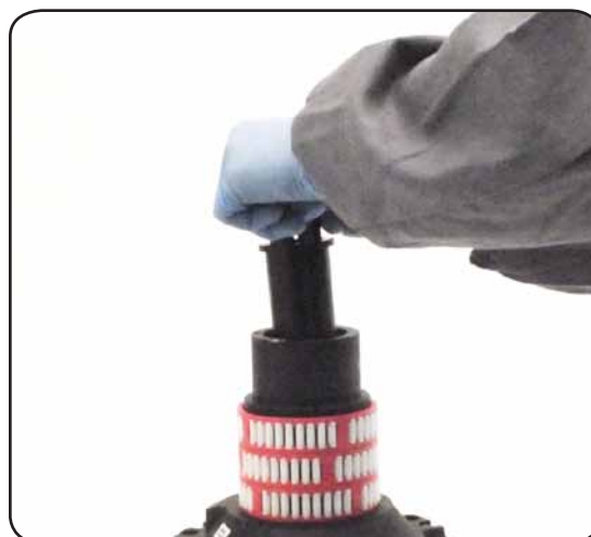
8. Slide out the assy clutch n°38
