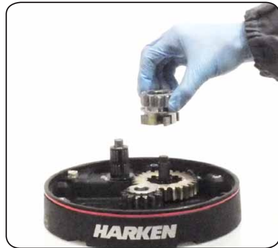
15. Remove the pawl carrier n°11
