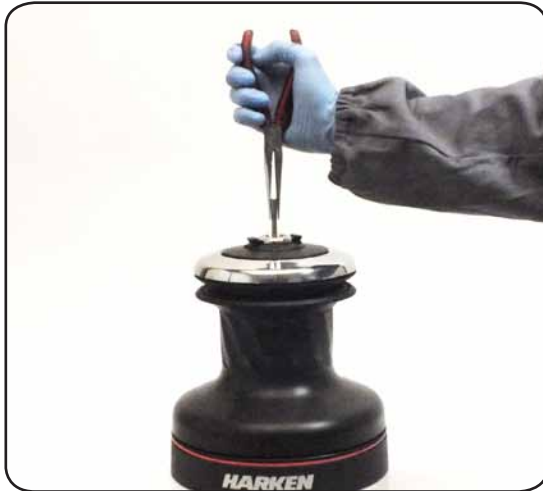
1. Pull out the disconnect rod n°39
