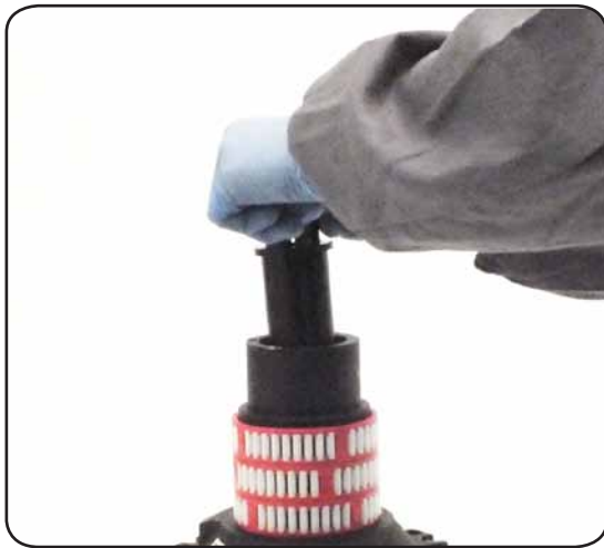
8. Slide out the assy clutch n°38
