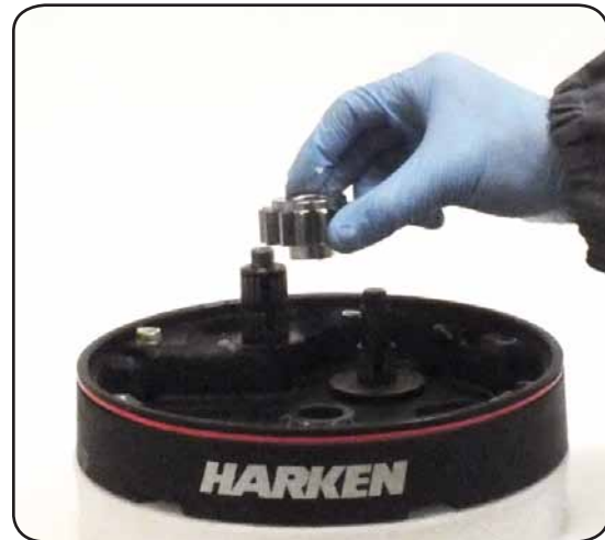
17. Remove the gear n°2
