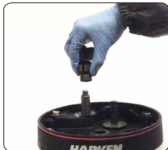
18. Remove roller bearings n°15
