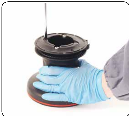
I. Unscrew the 4 screws ( \approx 4\text{Nm}/35\text{ in-lb} )
