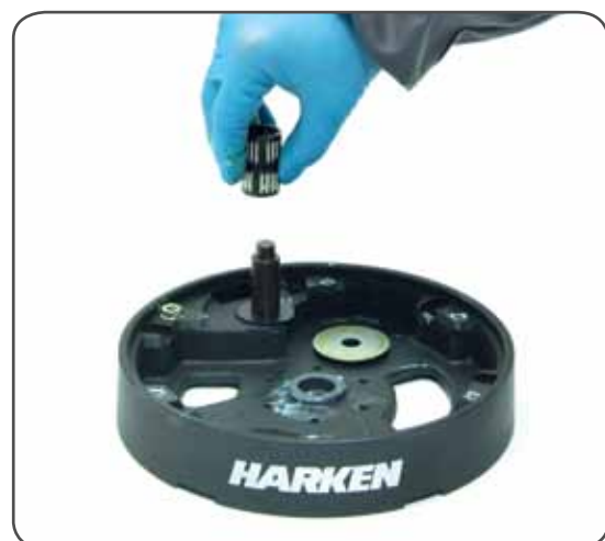
18. Remove roller bearings n°15
