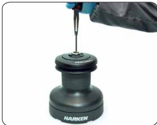
1. Pull out the disconnect rod n°38
