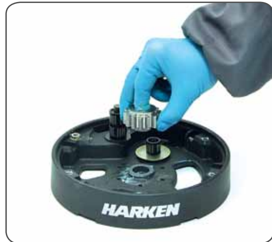
17. Remove the gear n°2
