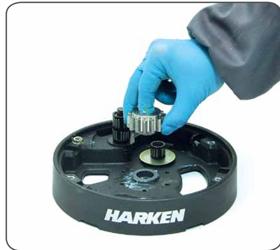
17. Remove the gear n°2
