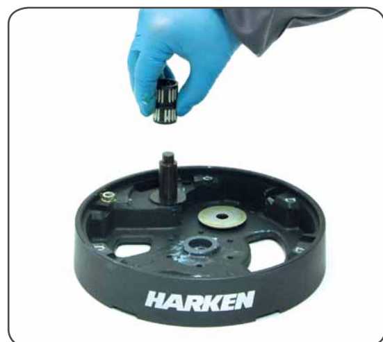
18. Remove roller bearings n°15
