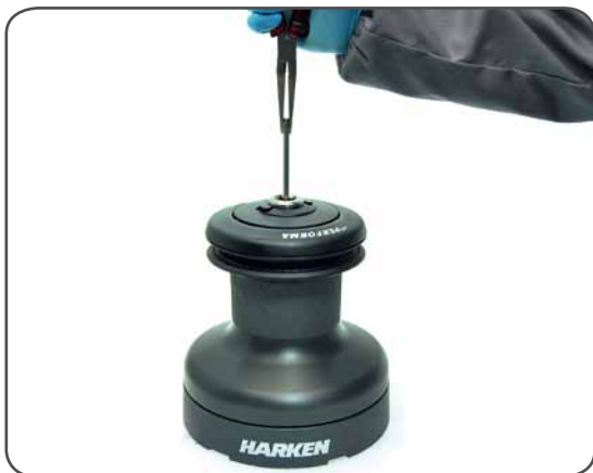
1. Pull out the disconnect rod n°38
