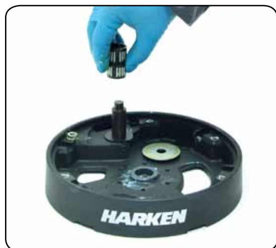
18. Remove roller bearings n°15
