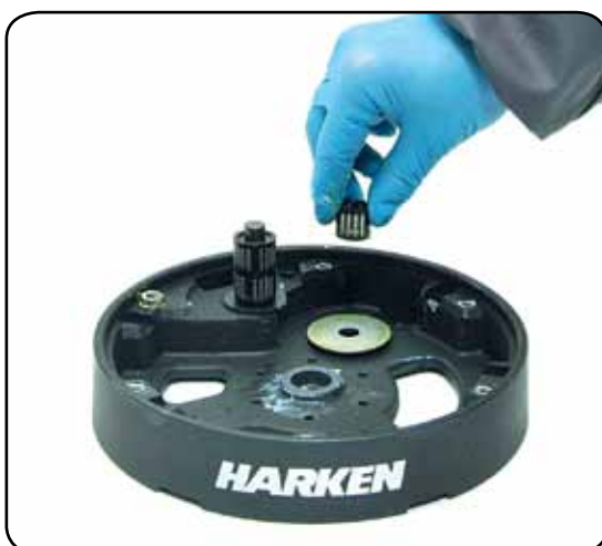
17. Remove roller bearing n°12
