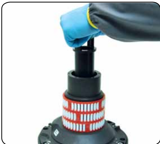
7. Slide out the assy clutch n°36
