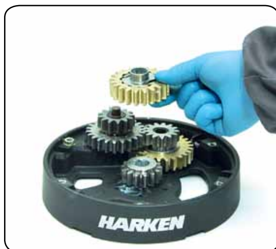
12. Remove gear n°6, pawls carrier n°3 and washer n°7
