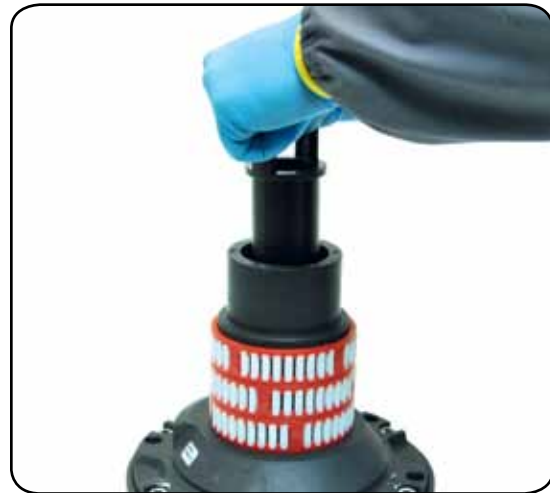
7. Slide out the assy clutch n°36
