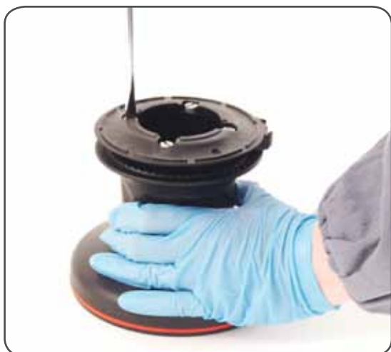
I. Unscrew the 4 screws n°10 ( \approx 4\text{Nm}/35\text{ in-lb} )
